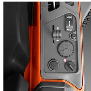
Startknopf drehen und losfahren. Keinen Choke nötig.
