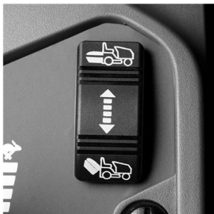
Auffangbox vom Sitz aus per Knopfdruck leeren.
